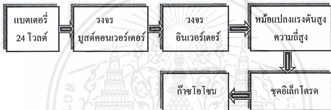
รูปที่ 3.1 โครงสร้างของเครื่องกำเนิดก๊าซไอโซนความถี่สูง
