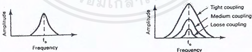
รูปที่ 2.48 ผลตอบสนองทางความถี่ของวงจรขยายสัญญาณความถี่กลาง
