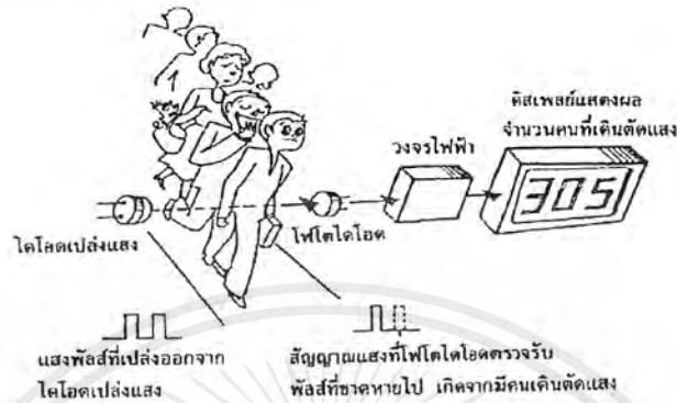
รูปที่ 2.31 ตัวอย่างการใช้งานสิ่งประดิษฐ์ออปโตอิเล็กทรอนิกส์ เพื่อวัดจำนวนคนที่เดินผ่าน
