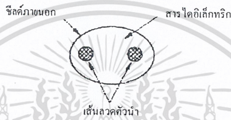
รูปที่ 2.5 สายส่งเส้นคู่ที่หุ้มด้วยสาร ไดอิเล็กทริก
