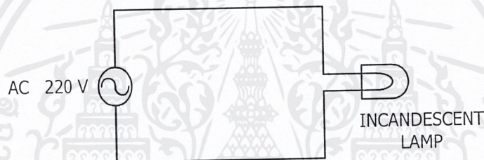
รูปที่ 2.1 วงจรการทํางานของหลอดไส้
