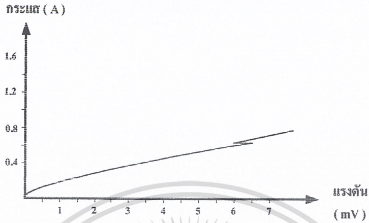
รูปที่ 4.5 กราฟแสดงความสัมพันธ์ระหว่างกระแสกับแรงดันของสารตั้งต้นแกลโคลิเนียม ที่อุณหภูมิการเผา 970 องศาเซลเซียส ขนาดแรงอัด 0.6 ตัน
