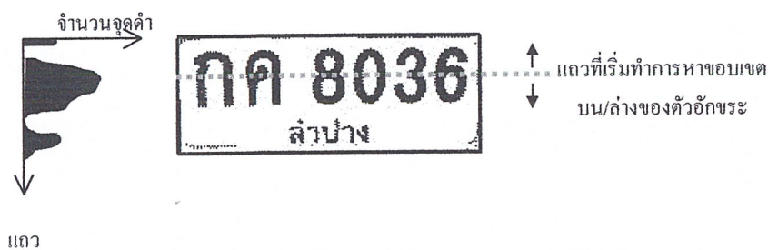
รูปที่ 4.9 แสดงการหาขอบบน/ล่างของตัวอักษรจากป้ายทะเบียนที่เป็นภาพขาวดำ
