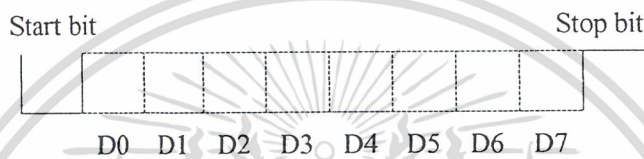
รูปที่ 2.20 สัญญาณของการส่งข้อมูลของโหมด 1
