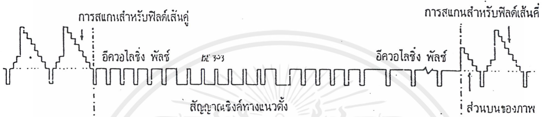
ข. รายละเอียดของสัญญาณซิงค์ทางแนวตั้ง (ภายหลังจากการสแกนสำหรับฟิล์มเส้นคู่แล้ว)
