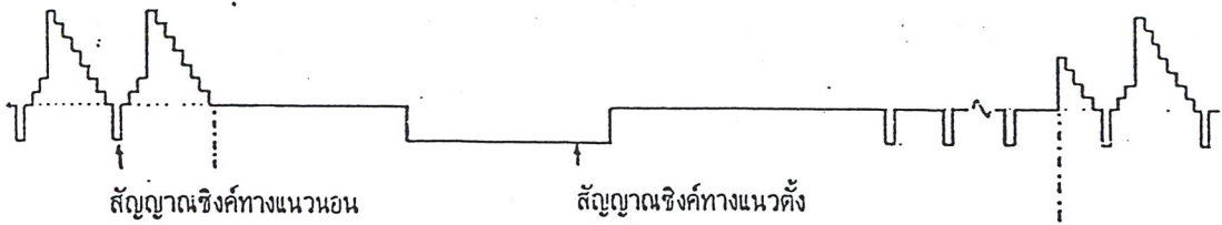
ก. สัญญาณภาพรวม แสดงให้เห็นสัญญาณภาพกับสัญญาณซิงค์ทางแนวนอน และสัญญาณซิงค์ทางแนวตั้ง
