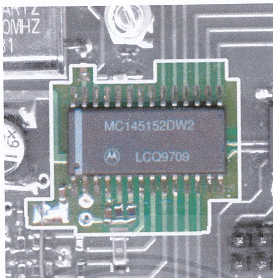
รูปที่ 3.25 วงจรเฟสดีเทกเตอร์ที่วางอุปกรณ์เรียบร้อยแล้ว
