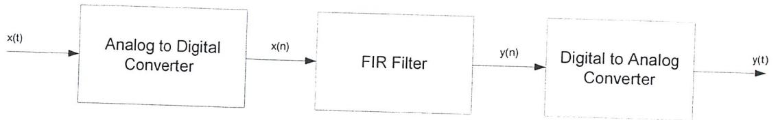
รูปที่ 3.10 บล็อกไดอะแกรมของวงจรกรองสัญญาณไม่ป้อนกลับเชิงเลข
