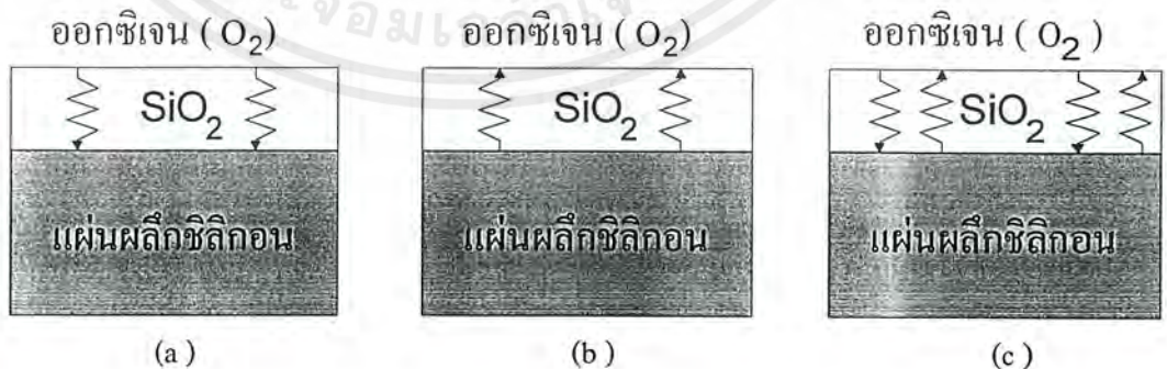
รูปที่ 3.2 แสดงกลไกของการเกิดขึ้นซิลิกอนไดออกไซด์ซึ่งอาจเกิดขึ้นได้ในลักษณะต่างๆ กัน
