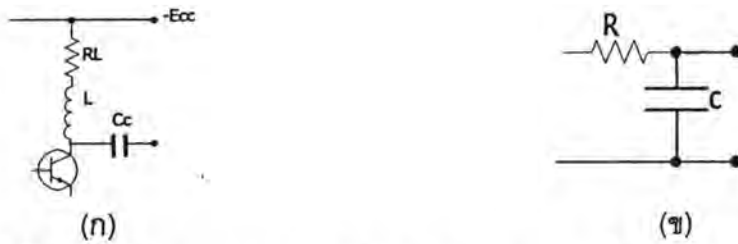
รูปที่ 3.6 ตัวอย่างวงจร (ก) วงจรปรับเอ็มฟาซิส (ข) วงจรดีเอ็มฟาซิส
