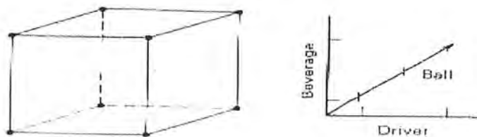
รูปที่ 2.7 แสดงรูปทรงเรขาคณิตของการออกแบบที่มีผลต่อ interaction ใน 2^3 design (Geometric presentation of contrasts corresponding to the main effects and interaction in the 2^3 design.)
