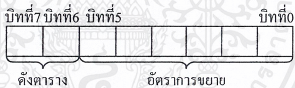
รูปที่ 4.2 ข้อมูลที่ส่งจากคอมพิวเตอร์ไปยังไมโครคอนโทรลเลอร์
