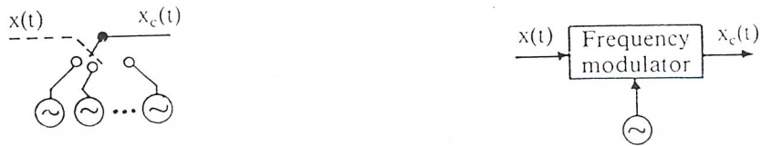
รูปที่ 2.4 การมอดูเลตสัญญาณดิจิทัลโดยการเปลี่ยนความถี่ของคลื่นพาห้
