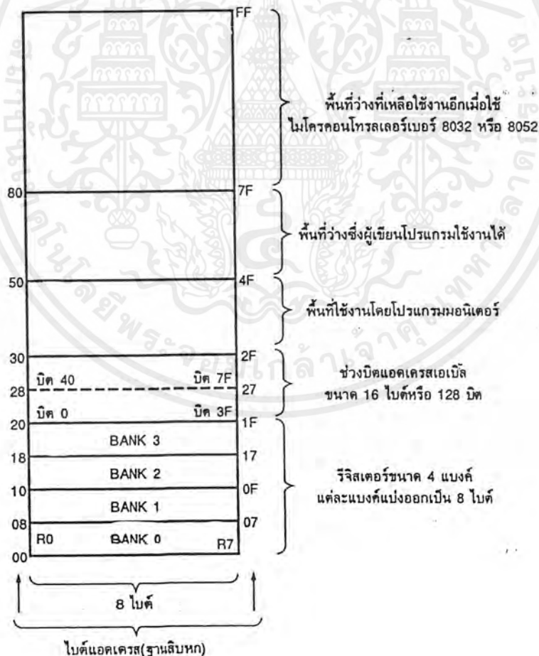
รูปที่ 2.19 แสดงแผนที่การจัดแบ่งช่วงแอดเดรสใช้งานของ RAM ภายใน
