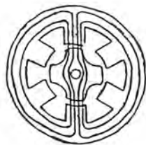
รูปที่ 2.3 แสดงตำแหน่งสมดุลย์เมื่อเฟสใดเฟสหนึ่งถูกกระตุ้น
