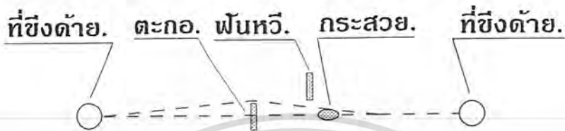
ภาพ ๒๑ ส่วนประกอบเครื่องทอผ้าแบบจำลองแบบที่ชิ้นงานเท่าตัวเครื่อง
