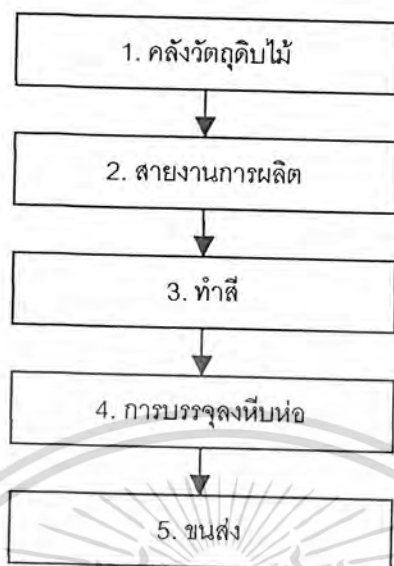
ภาพที่ 2.90 ภาพแผนผังแสดงขั้นตอนการผลิตเฟอร์นิเจอร์ไม้ยางพารา
