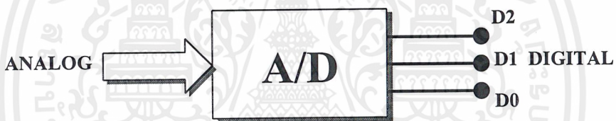
รูปที่ 3.10 ตัวแปลงสัญญาณอนาลอกเป็นดิจิทัลขนาด 3 บิต
