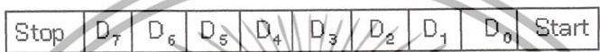
รูปที่ 2.13 แสดงบิตต่าง ๆ ของข้อมูลที่ส่งแบบอนุกรม
