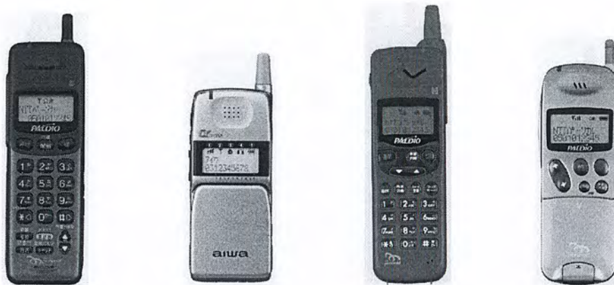
รูปที่ 2.25 แสดงเครื่อง PS ของระบบโทรศัพท์พื้นฐานพกพาส่วนบุคคลพีซีที
