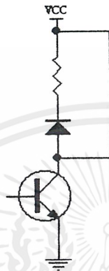
รูปที่ 2.19 แสดงการใช้ไดโอด และรีซิสเตอร์ซัพเพรสเซอร์
