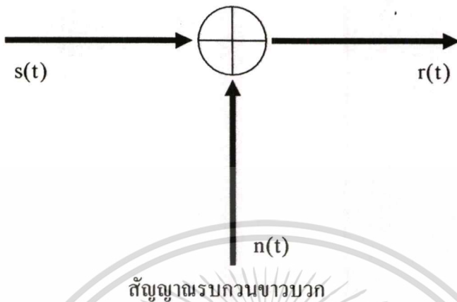
รูปที่ 3.9 การปรากฏของสัญญาณรบกวนขาวววกแบบเกาส์ที่เครื่องรับ
