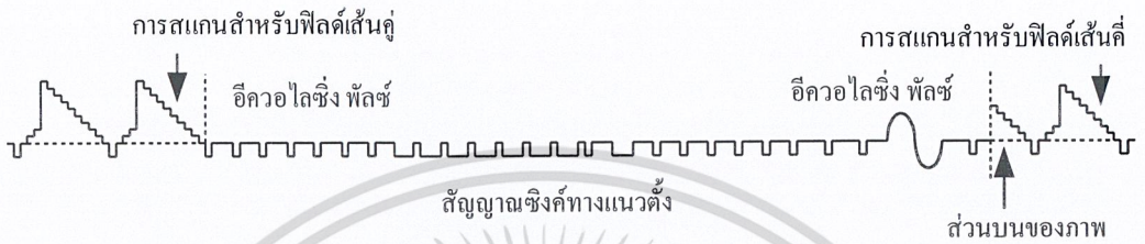
ข. รายละเอียดของสัญญาณซิงค์ทางแนวตั้ง (ภายหลังการสแกนฟิลด์เส้นคู่แล้ว)
