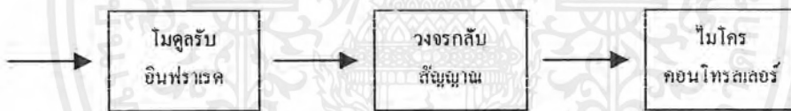
รูปที่ 3.4 บล็อกไดอะแกรมของวงจรภาครับอินฟราเรด
