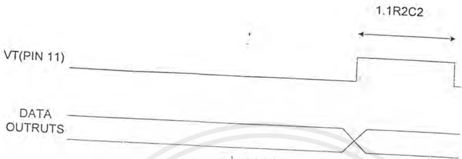
รูปที่ 1.8 ไทม์มิ่งไคอาแกรมของ MC145027
