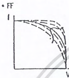
รูปที่ 2.17 เซลล์ไม่คู่ควรกันต่ออนุกรมเกิดปัญหาการสูญเสียกำลังจำลองโดยใช้การกระจายตัวขององ
