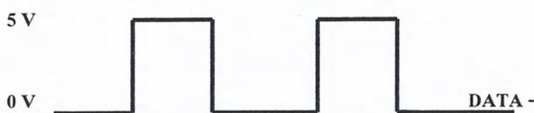
รูปที่ 2.1 ลักษณะของสัญญาณข้อมูล DMX
