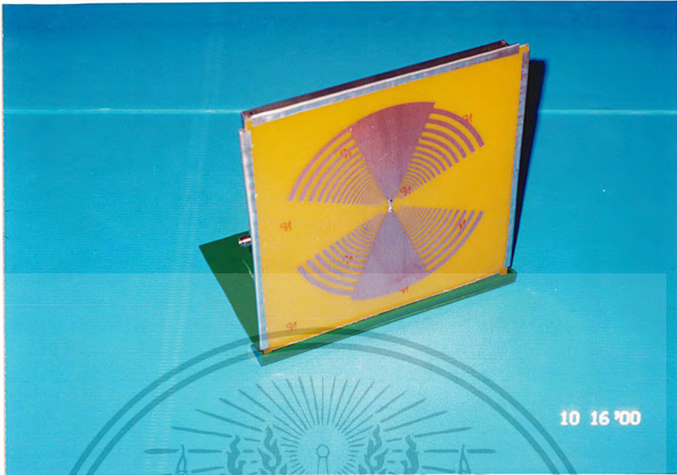
รูปที่ 4.6 สายอากาศแบบระบายคาบถ่วงบนหัวเสาฐานรองไดอิเล็กทริกโครงสร้างที่ 2
