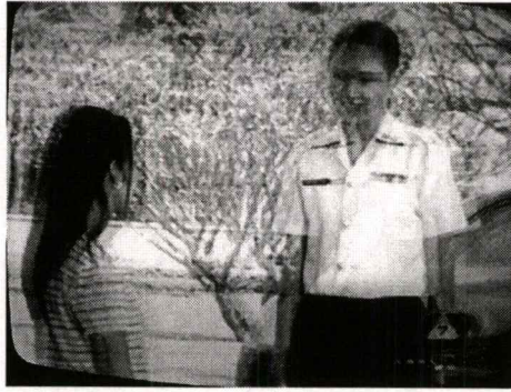
รูปที่ 2.2 ตัวอย่างการเกิดภาพซ้อนบนจอเครื่องรับโทรทัศน์
