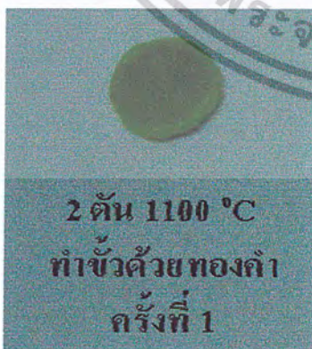
รูปที่ ๘.13 ชิ้นสารตัวอย่างขึ้นรูปด้วยแรงอัด 2 ตัน เผาอบที่อุณหภูมิ 1100°C ชั้นที่ 1
