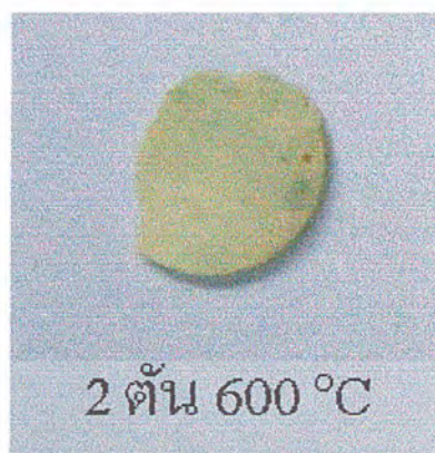
รูปที่ ๓.4 ชิ้นสารตัวอย่างขึ้นรูปด้วยแรงอัด 2 ตัน
