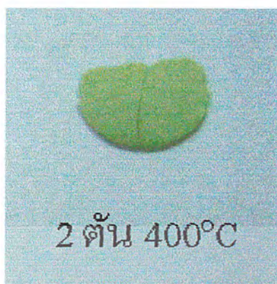
รูปที่ ๓.3 ชิ้นสารตัวอย่างขึ้นรูปด้วยแรงอัด 2 ตัน
