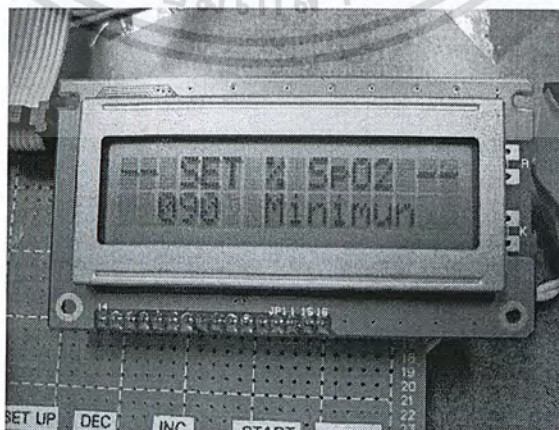
รูปที่ 2 แสดงผลที่ออกมาทางจอ LCD เมื่อกดสวิทช์เพิ่มค่า-ลดค่า
