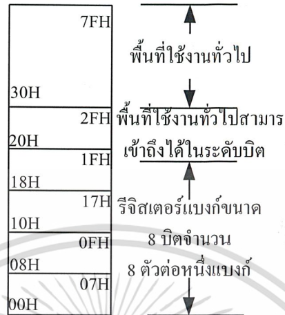
รูปที่ 2.28 การจัดสรรพื้นที่ของหน่วยความจำภายในส่วนล่างของไมโครคอนโทรลเลอร์ MCS-51
