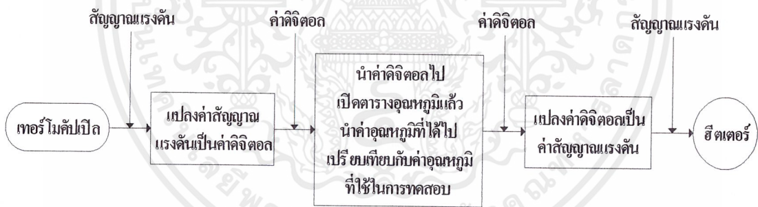
รูปที่ 3.16 แสดงไคอะแกรมการทำงานของ โปรแกรมย่อยการควบคุมอุณหภูมิ
