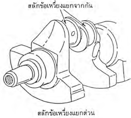
รูปที่ 2-6 แสดงเพลาคือข้อเหวี่ยงมาตรฐานของเครื่องยนต์ V-6 เปรียบเทียบกับเพลาคือข้อเหวี่ยงของเครื่องยนต์ V-6 ที่มีสลักข้อเหวี่ยงแยกส่วน
