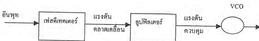
รูปที่ 2.16 แผนผังวงจรเฟสล็อกกลูป
