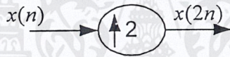
รูปที่ 2.18 แสดงการซีกค่าการสุ่มตัวอย่างขึ้นสองเท่า
