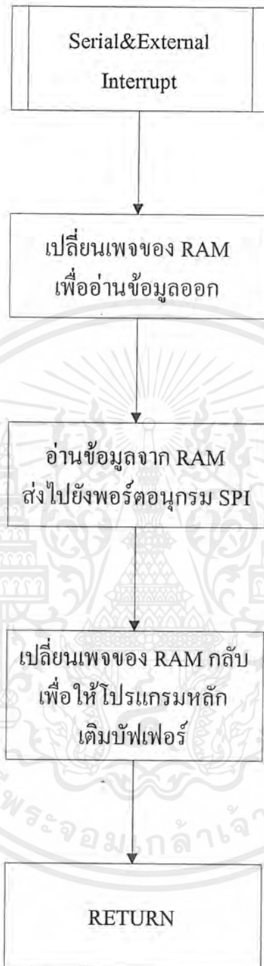
รูปที่ 7.7 โฟลว์ชาร์ทของโปรแกรมบริการอินเทอร์รัพท์พอร์ตอนุกรมและสัญญาณตีฆานต์
