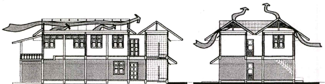
รูปที่ 4.26 แสดงรูปแบบเรือนที่ทำการปรับปรุงการระบายอากาศบริเวณภายในหลังคา
