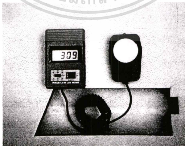
รูปที่ 3.72 แสดงอุปกรณ์วัดแสงสว่าง
