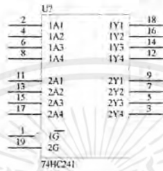
รูปที่ 3.10 แสดงรูป IC ที่ใช้ในวงจรอินพุตของเครื่องตรวจสอบ
