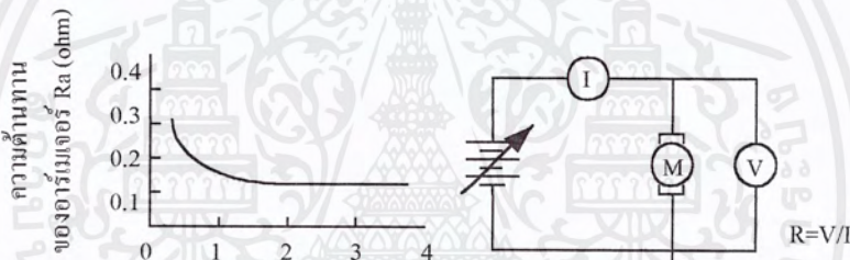
รูปที่ 3.6 การวัดความต้านทานของอาร์เมเจอร์ด้วยการทดสอบกระแส
