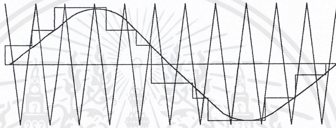
รูปที่ 2.26 การสร้างรูปคลื่นแบบเรกกูลาร์แชนเปลิ่งชนิดสองระดับ
