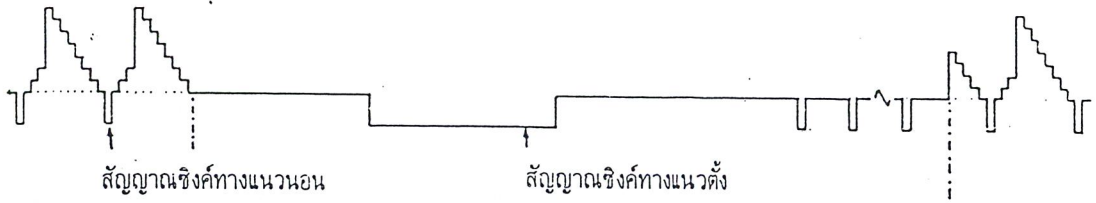
ก. สัญญาณภาพรวม แสดงให้เห็นสัญญาณภาพกับสัญญาณซิงค์ทางแนวนอน และสัญญาณซิงค์ทางแนวตั้ง
