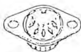
คอนเนคเตอร์สำหรับคีย์บอร์ดแบบ DIN (5 ขา)
