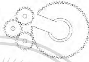
รูปที่ 1.12 แสดงการหมุนของเฟืองรูปตัวซีเมื่อมีเฟืองขับ 3
