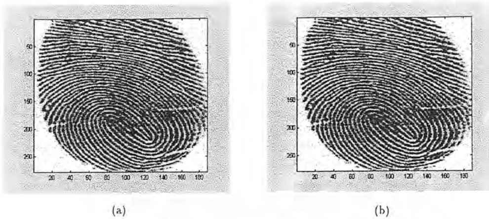
รูปที่ 2.3 แสดงการทำออร์มัลไลเซชันภาพลายนิ้วมือ a. ภาพลายนิ้วมือก่อนการทำออร์มัลไลเซชัน b. ภาพลายนิ้วมือหลังการทำออร์มัลไลเซชัน
