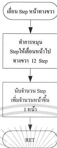
รูปที่ ค.8 ผังการทำงานของการทำงานการเลื่อนหน้าแผ่นใสไปทางขวาเป็น Step
