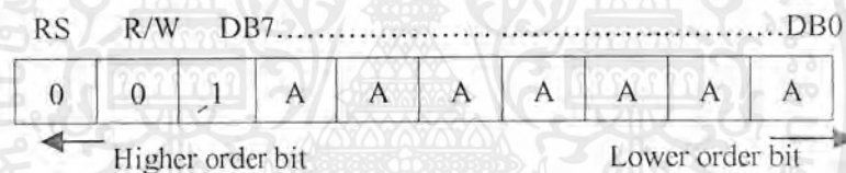
รูปที่ 24 แสดงคำสั่ง SET DD RAM ADDRESS
