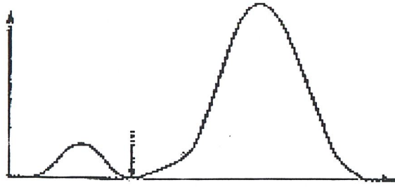
ภาพที่ 2.6 แนวคิดในการคำนวณค่าเทรซโฮลด์โดยวิธีพิจารณาจากฮีสโตแกรม
