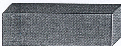
รูปที่ 1.5. แสดงคานคอนกรีตลูกบาศก์ ขนาด 15x15x60 ซม. 3 สำหรับ Flexural Strength Test
